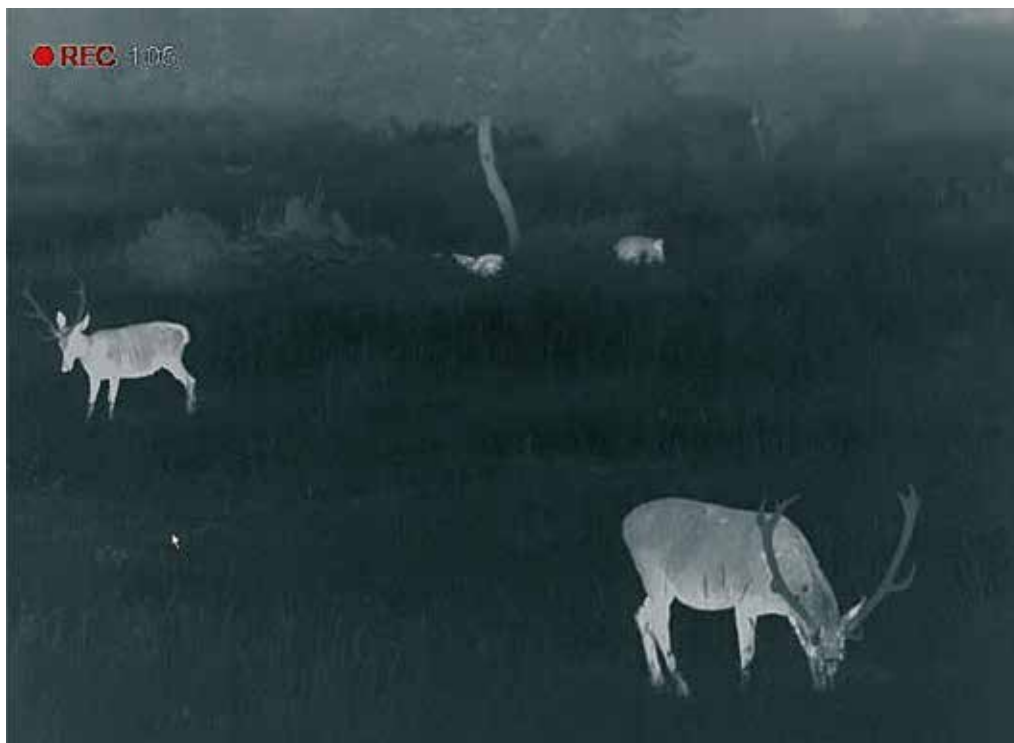
Wärmebildgeräte zeigen Temperaturunterschiede auf. Sie eignen sich, um Wild – aber auch andere Wärmequellen – zu detektieren.
