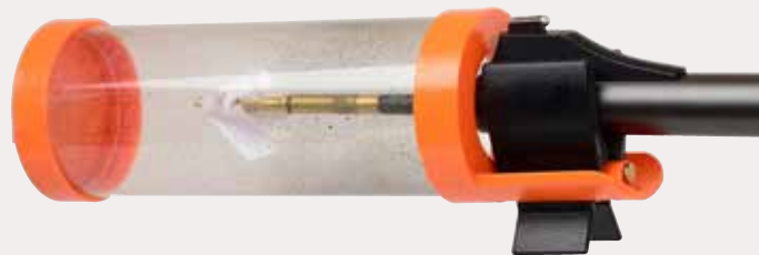
Bild 3: Damit die schmutzigen Pfropfen und die Spritzer der mit Solvent getränkten Bronzebürste nicht überall auf dem Tisch zu finden sind, hat sich ein spezieller Schmutzsammelbehälter bewährt.
