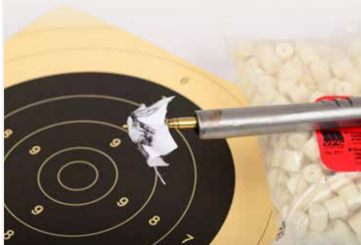
Bild 4: Ein auf den kaliberpasenden Messingdorn aufgespießter Baumwollfleck verlässt die Laufmündung. Statt Baumwollflecken können auch kalibergerechte Filze verwendet werden.
