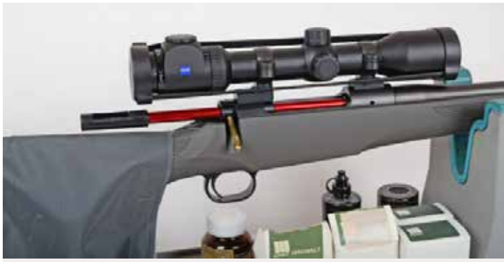
Bild 5: Das Zielfernrohr wurde mit einer speziellen Staubschutzabdeckung, dem so genannten Bikini, geschützt, damit keine Solvent-Spritzer die Vergütung der Linse angreifen. Das Schloss wurde gegen die Putzstockführung ausgetauscht.
