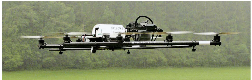
Knappe zwei Kilo wiegt das ferngesteuerte Fluggerät mit Akku und Infrarotkamera.
