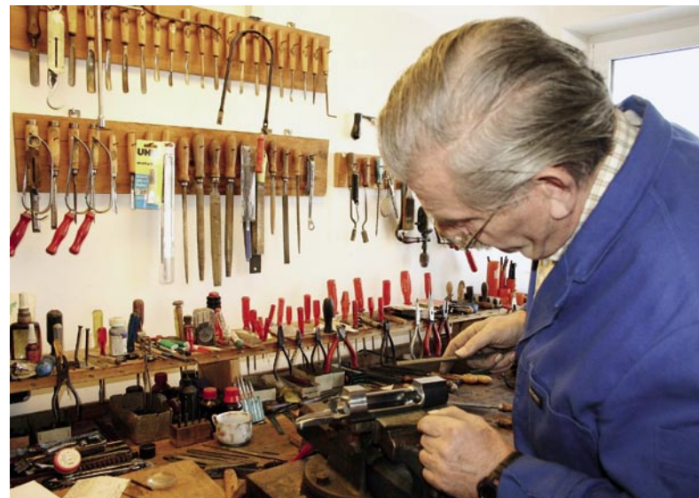
Der Büchsenmacher muss die einzelnen Systemteile immer wieder feilen und schleifen, bevor sie sich nahtlos zusammenfügen lassen.
