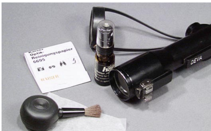
Die Linse der Zieloptik muss entstaubt und entfettet werden.
