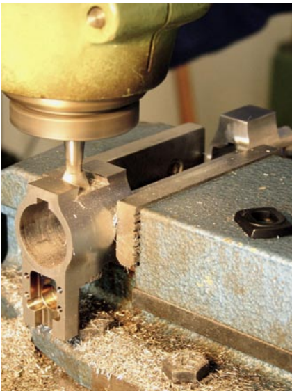
In die „Square Bridge“ wird der Schwalbenschwanz für die Zielfernrohrmontage gefräst.
