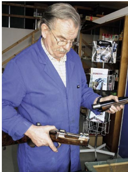
Mit einem Handgriff lässt sich eine Waffe mit Take Down-Mechanismus auseinandernehmen.
